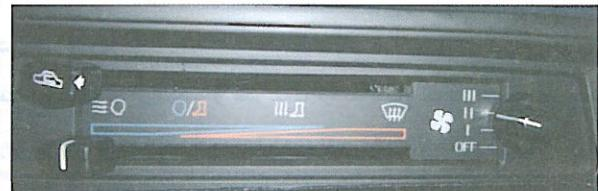
برای گرم شدن اتومبیل هوا گرم از کانالهای شماره ۱ و ۴ وارد می شود. (شکل صفحه ۵۳)
