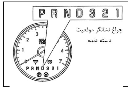
چراغ نشانگر جعبه دنده (گیربکس) اتوماتیک در
