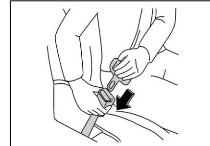
۴. کمربند اینمنی باید از روی شانه عبور کند و اطمینان حاصل کنید که کمربند از میان شانه عبور کرده باشد و از نواحی گردن به دور باشد.
